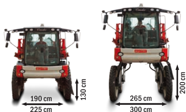
Bij Condor MountainMasterPlus zijn hoogtevinstellingen mogelijk van 130 tot 200 cm en breedte verstellingen van óf 190 tot 265 cm, óf 225 tot 300 cm.
