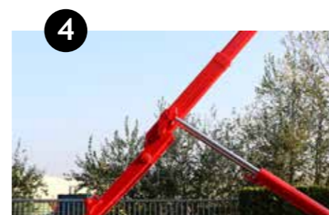
4 Grote kiphoek schuifarm en grote schuifslag
