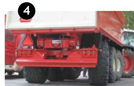
4 Grote stuurhoek, óók bij brede banden
