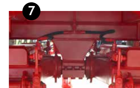
7 Heavy Duty montage van pendelas
