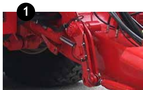
1 Commandocilinder(s) op beschermde positie
