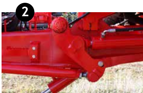
2 Spelingvrije overbrenging van stang naar cilinder
