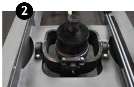
2 Cardanische ophanging kipcilinder
