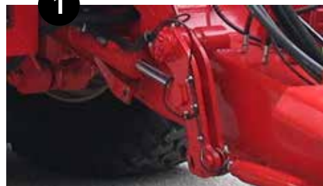
Commandocilinder(s) op beschermde positie
