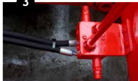
Hydraulisch systeem zonder accumulatoren
