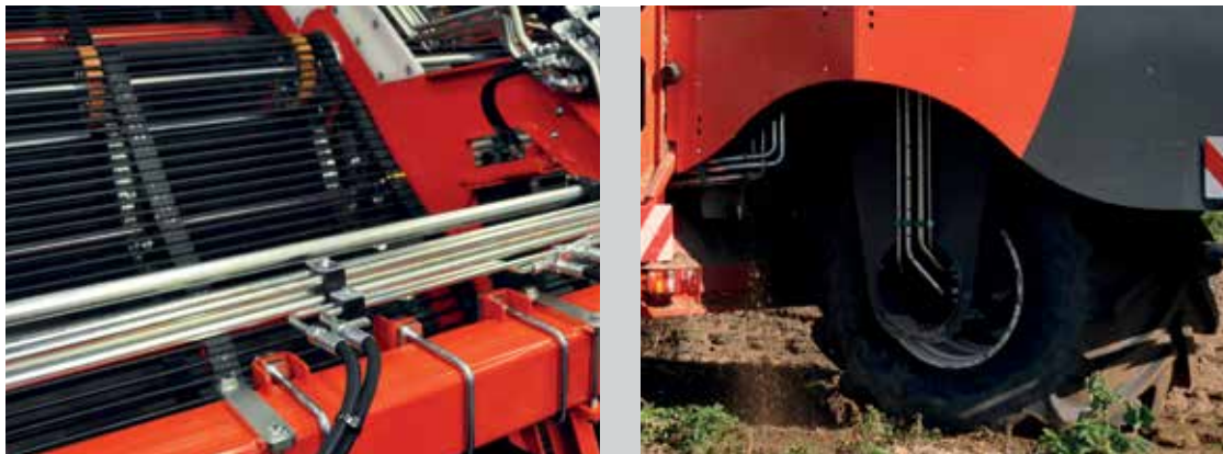
Maximaal gebruik van buisleidingen = geen wrijving tussen slangleidingen
