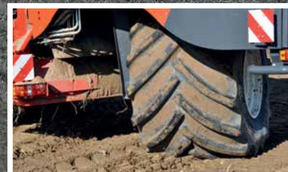
Superbreed achterwiel (1250/50 R32) met een bandenspanning van 1,4 bar.
