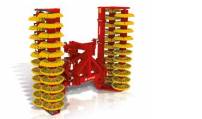
Hydraulisch opklapbaar - zo kunnen Ook, grote werkbreedtes, veilig getransporteerd en plaatsbesparend afgesteld worden.
