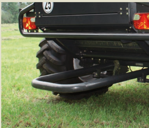
De balenwip laat de bal sneller wegrollen. Hierdoor kan de achterklep snel weer dicht en gaat de capaciteit omhoog (optie)
