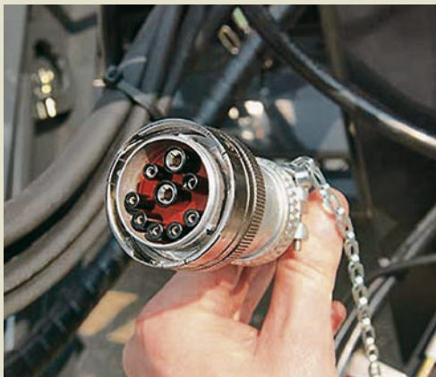
ISOBUS geeft maximaal comfort in bediening (FB 3135 & FBP 3135)
