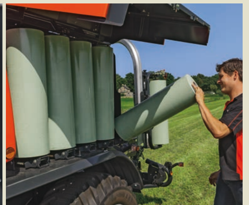
Afgesloten foliekast voor 10 rollen wikkelfolie
