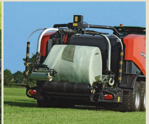
3D wikkelen voor goed gevormde, strak gewikkelde balen (optie)
