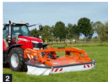
1. Horizontaal inklapbare schijvenmaaier 2. Frontschijvenmaaier 3. Getrokken maaiknikschudder 4. Triple-maaicombinaties met knikrotor
