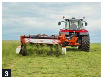
1. Horizontaal inklapbare schijvenmaaier 2. Frontschijvenmaaier 3. Getrokken maaiknikschudder 4. Triple-maaicombinaties met knikrotor
