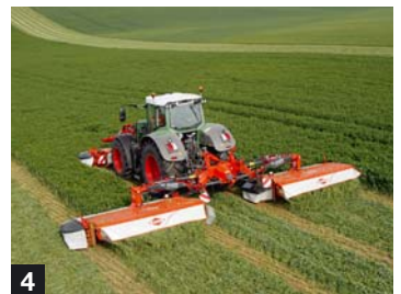
1. Horizontaal inklapbare schijvenmaaier 2. Frontschijvenmaaier 3. Getrokken maaiknikschudder 4. Triple-maaicombinaties met knikrotor
