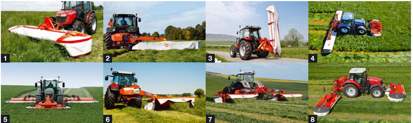
1. Schijvenmaaier voor frontaanbouw 2. Horizontaal inklapbare schijvenmaaier 3. Verticaal inklapbare schijvenmaaier 4. Triple-schijvenmaaier 5. Frontmaaiknikschudders 6. Gedragen maaiknikschudders 7. Triple-maaicombinaties met knikrotor 8. Trommelmaaier
