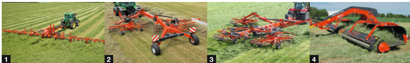
1. Getrokken cirkelschudder met 13 en 17 m werkbreedte 2. Getrokken dubbele rotorcirkelhark 3. Vier rotoren cirkelhark 4. Bandhark
