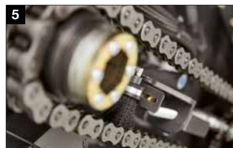
5 Robuuste, brede oliekwasten op kettingen waarborgen perfecte smering
