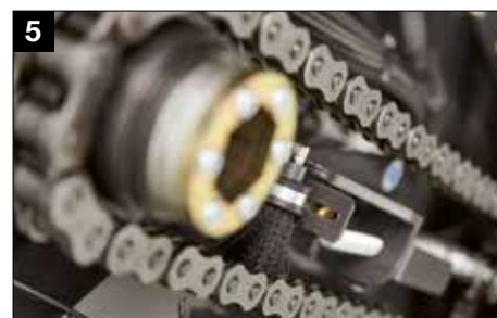
Robuuste, brede oliekwasten op kettingen waarborgen perfecte smering
