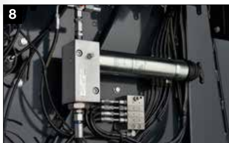
8 Standaard automatisch smeersysteem voor rol-lagers
