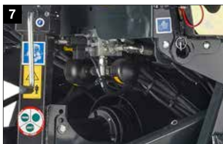
7 Standaard proportionele klep voor persdichtheid in cabine
