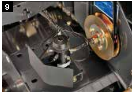
Beka Max continu kettingsmeringssysteem
