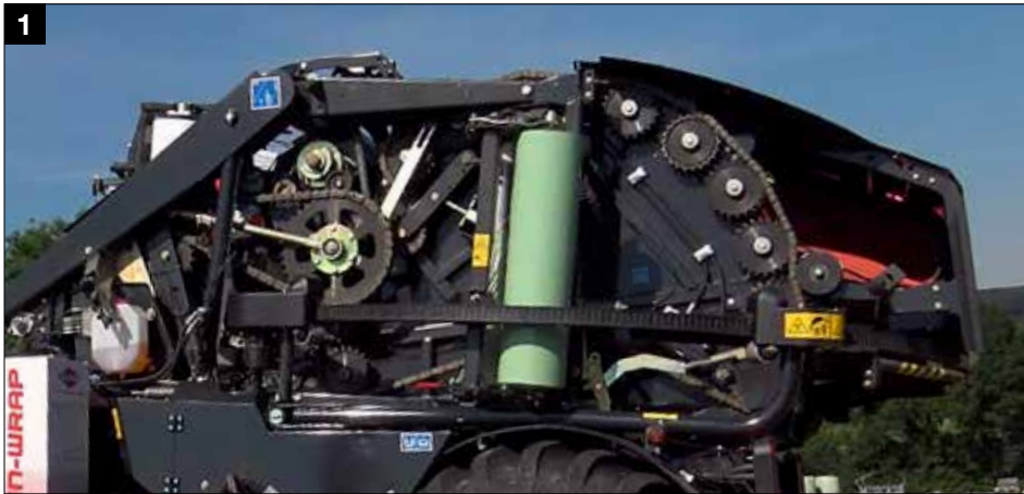
1 Robuuste aandrijflijn met IWS-kettingen van hoge kwaliteit
