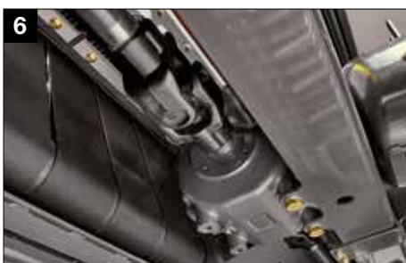
Zwaar uitgevoerde cardankoppelingen in aandrijfassen
