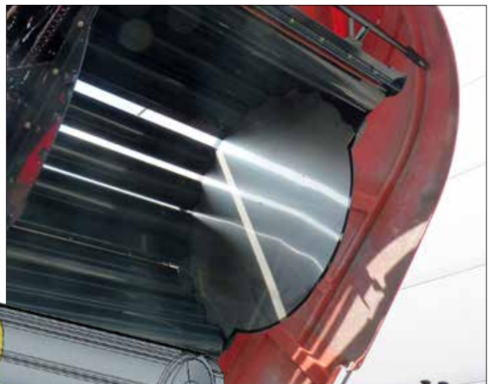
Roestvrijstalen platen met lage wrijving
