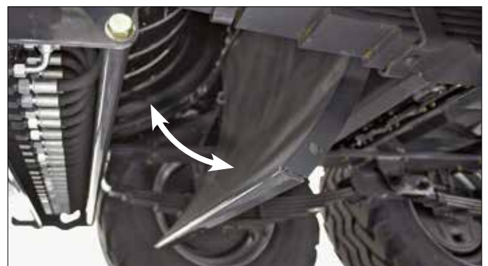
Inspectievlak in de voorkamer
