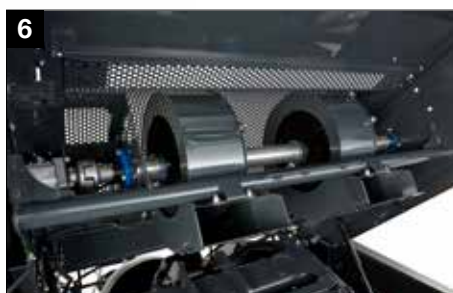
Turbines voor knopperreiniging
