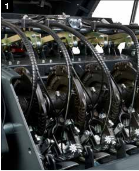
Dubbel knoopsysteem met standaard elektronische bewaking
