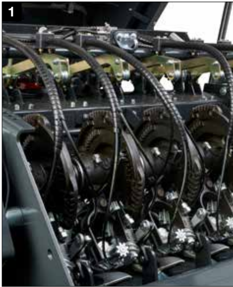
1 Dubbel knoopsysteem met standaard elektronische bewaking
