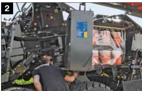
Zwenkbare touwkasten voor gemakkelijk onderhoud
