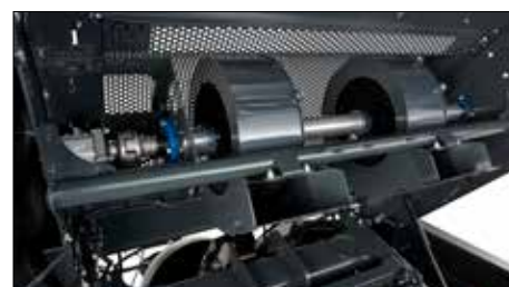
Modellen met dubbele knopers: hydraulisch aangedreven ventilatoren
