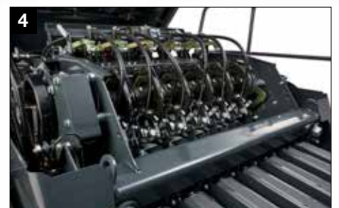
Dubbel knoopsysteem met standaard elektronische bewaking
