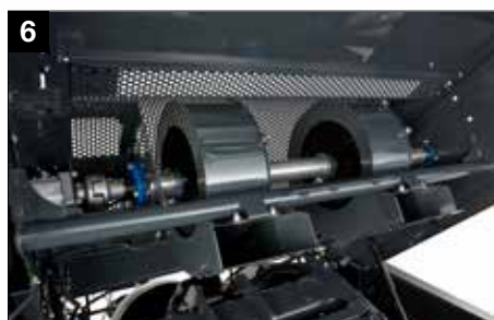
Turbines voor knopperreiniging
