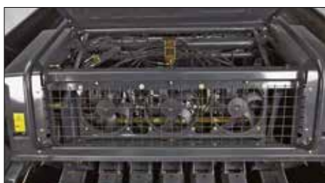
TWIN STEP modellen: elektrische knoperventilatoren
