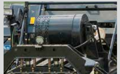
Hydraulisch aangedreven turboventilator (alleen voor LSB 1270)
