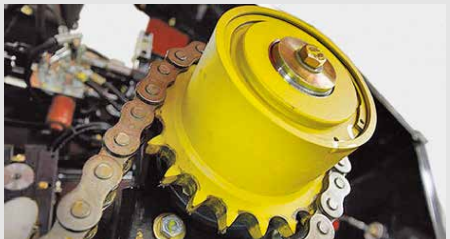
Beveiliging INTEGRALE ROTOR met nokkenslipkoppeling
