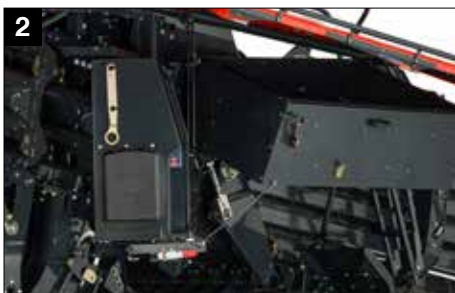
Zwenkbare touwkasten voor gemakkelijk onderhoud
