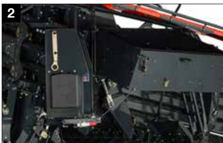
2 Zwenkbare touwkasten voor gemakkelijk onderhoud
