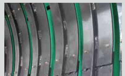
Teflon (Easy Flow) platen voor voorkamer
