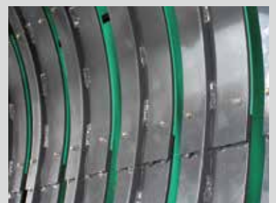
Teflon (Easy Flow) platen voor voorkamer
