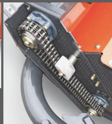
Kneusrotorsnelheid van 815 \text{ min}^{-1} kan veranderd worden in 650 \text{ min}^{-1} door het wisselen van tandwielen.
