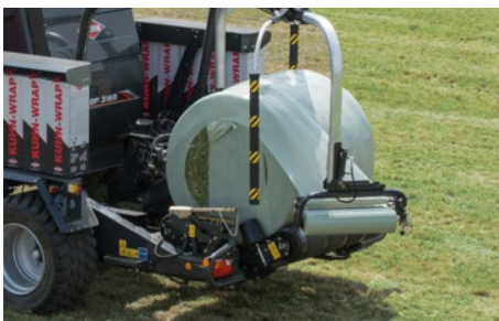
Start van 3D-wikkelen waarbij de schouders van de baal bedekt worden.
