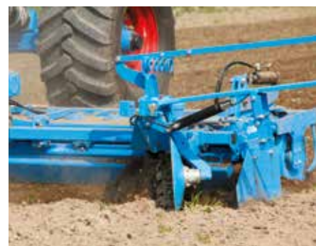
Randschijven voor precieze aansluiting
