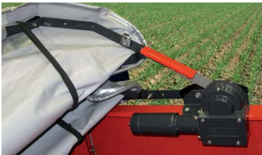
Elektrisch, op afstand bedienbaar afdekzeil
