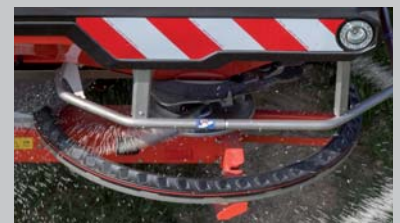
AXMAT duo: Door radar ondersteunde, automatische strooibeeldcontrole en -regeling (zie pagina 12)
