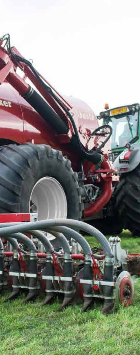
Luchtcilinder sluit en opent mesttoevoer, altijd handmatige afsluiting mogelijk
