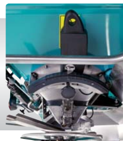
TRIBORD 2D : kantstrooien vanuit de cabine
