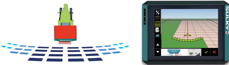
ISOBUS ECONOV stuurt 12 gelijke secties aan, onafhankelijk van de werkbreedte (hier met volle werkbreedte met 12 secties open)
