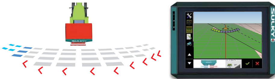
Rechterzijde gesloten, progressief afsluiten van de secties aan de linkerzijde, vanuit het midden naar de buitenkant.
