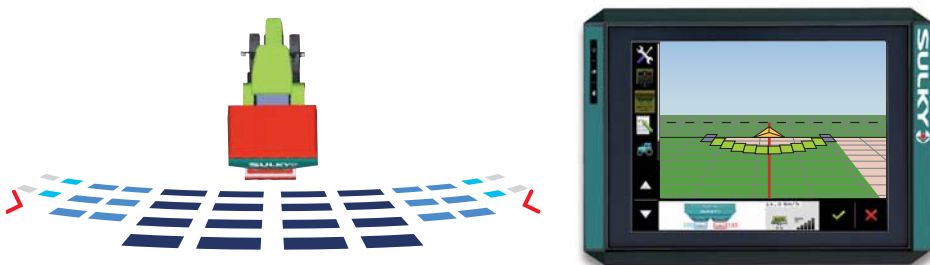
Bij naderen van een rechte lijn op de kopakker zullen de secties progressief sluiten vanaf de buitenkant naar het midden. Het werkelijke strooibeeld wordt dus gerespecteerd.... in een CURVE!
