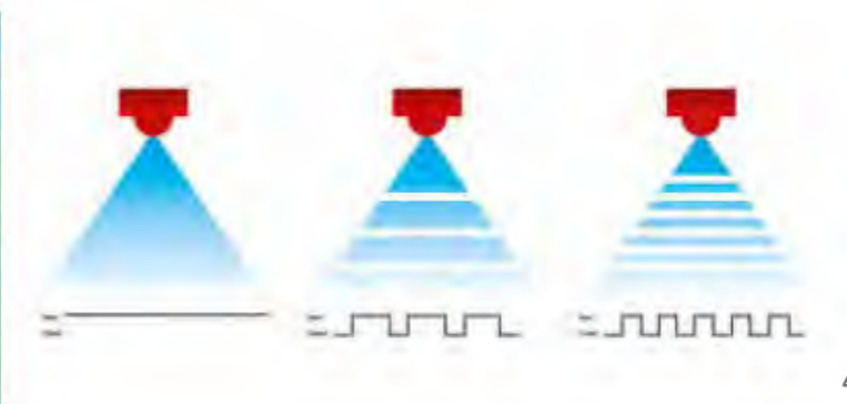
StrictSprayPlus berekent de snelheid en de gewenste hoeveelheid voor iedere spuitdop
