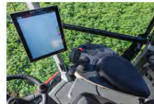
EcoTronicPlus in de Condor Endurance: Een volledig nieuwe bediening, bestaande uit het scherm en een volledig geïntegreerde armleuning en joystick.
