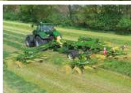
Swadro TC 1370 Middenafleghark met vier elementen Variabele werkbreedte van 10,80 m tot 13,70 m
