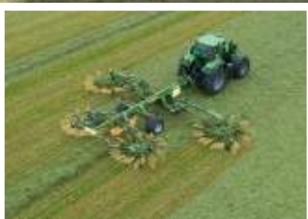
Swadro TC 1250 / 1250 Plus Middenafleghark met vier elementen Variabele werkbreedte van 9,80 m tot 12,50 m
