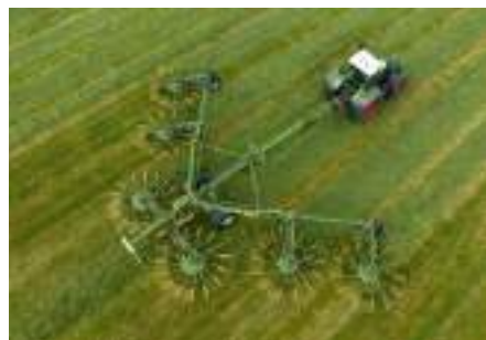
Swadro TC 2000 Middenafleghark met zes elementen Variabele werkbreedte van 10,00 m tot 19,00 m
