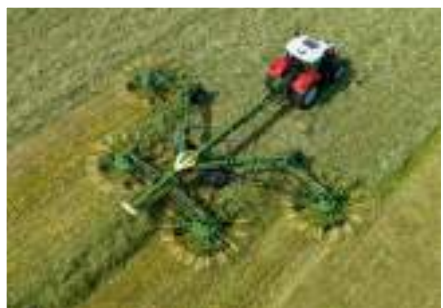
Swadro TC 1570 Middenafleghark met vier elementen Variabele werkbreedte van 11,00 m tot 15,70 m
