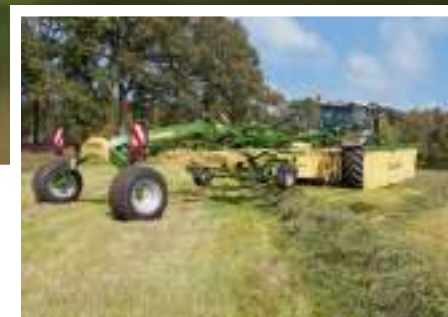
Swadro TS 680 Twin Werkbreedte 6,80 m / (2x 3,80 m)
