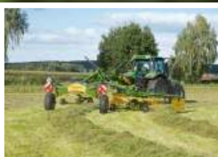
Swadro TS 620 Twin Werkbreedte 6,20 m / (2x 3,46 m)
